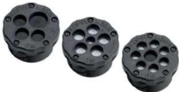
KDP/R - рациональный способ подключения без использования инструмента для кабельных соединений машин и установок. Очень быстрый монтаж проводов и пневматических шлангов. Альтернатива резьбовому кабельному вводу. Для защелкивания или привинчивания с помощью контргайки.
