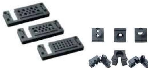
Панели типа KDP 24-Multi — это комбинация из системы KDP и KDL/E. Они идеально подходят в случаях, когда наряду с проводами без штекерных соединителей в распределительный шкаф необходимо ввести несколько проводов со штекерами. Эти плиты с кабельными вводами вмещают до восьми предварительно укомплектованных кабелей в двух втулках.
