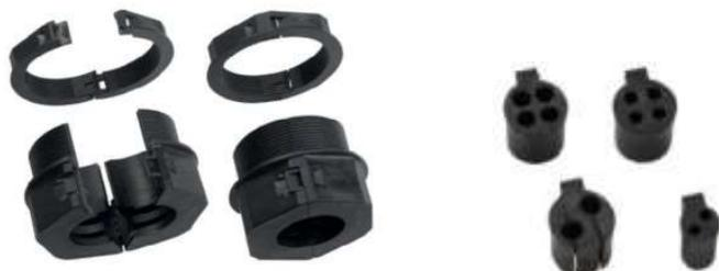
KDL/D-mono — это разъемная панель с кабельными вводами, предназначенная для ввода предварительно укомплектованных проводов. В зависимости от выбранной втулки для кабельного ввода можно прокладывать до четырех проводов. Разъемная контргайка входит в комплект поставки. Преимущества:
